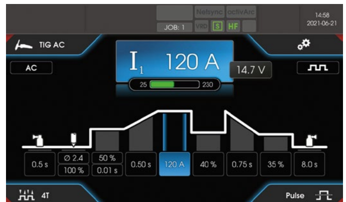
Grafische aanpassing van alle parameters in stroomdiagram
