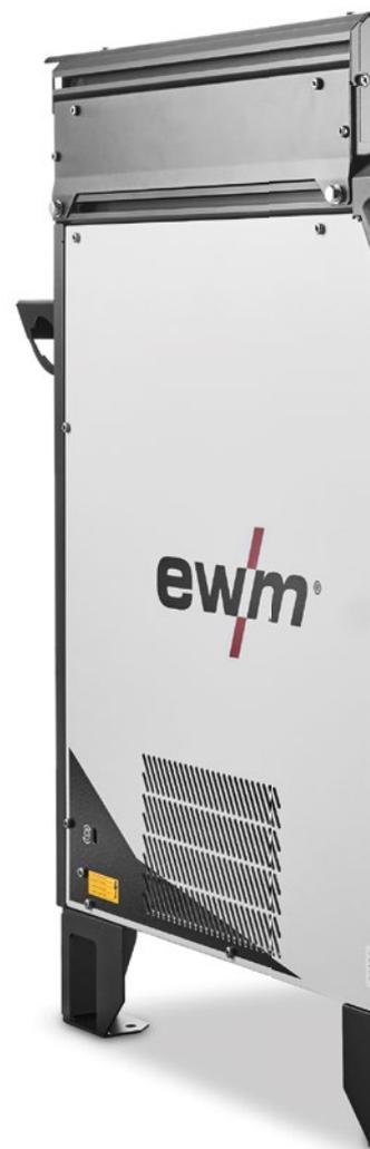
Grâce au procédé de soudage à courant alternatif du Titan XQ R 400 AC puls, le soudage MIG de l'aluminium est encore plus aisé dans les applications manuelles et automatisées. Des cordons de soudure propres sans traces de fumée sont possibles sur des tôles ultrafines même en alliage de AlMg grâce au procédé MIG-AC.
