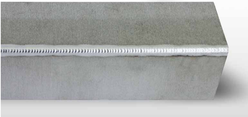
AC-specjalne – Zewnętrzna spoina narożnikowa, 3 mm
