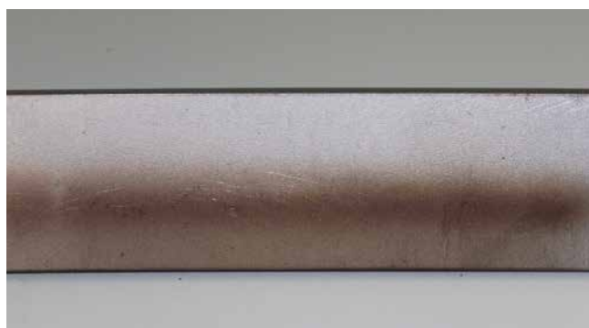
Parte posterior: escaso aporte de calor con forceArc puls®, menor oxidación de la superficie
