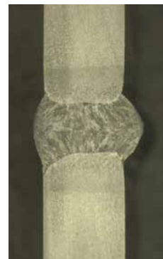
Chapa de 5 mm de grosor Separación 3 mm
