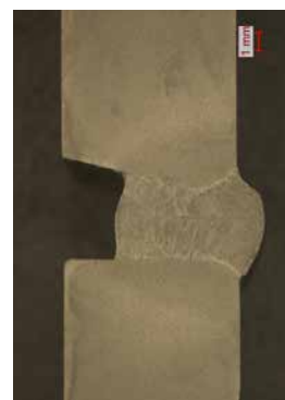
Chapa de 10 mm de grosor, bisel en un lado de 15 grados, separación de 4 mm
